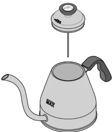
2. Füllen Sie den Wasserkessel höchstens bis zur Markierung **MAX** mit Wasser. Andernfalls kann am Deckel und/oder am Schwanenhals siedendes Wasser herausspritzen.
