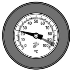
An dem im Deckel integrierten Thermometer können Sie die Wassertemperatur im Kessel genau ablesen.
